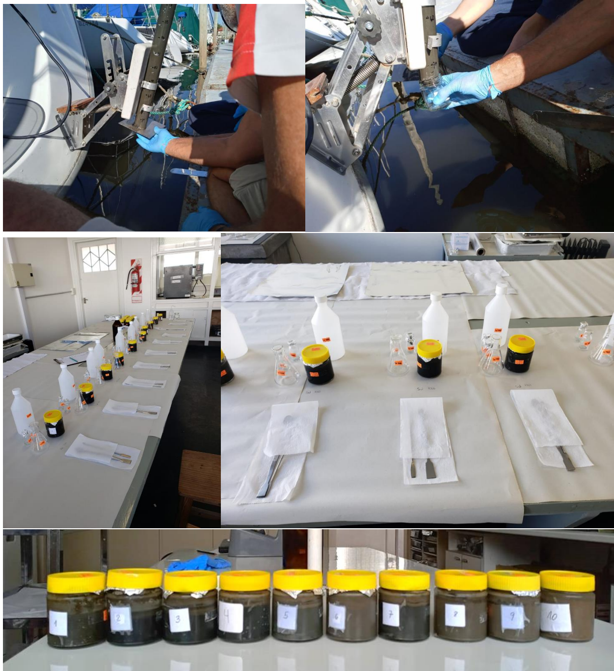
Figura 2. Fotografías del seccionamiento de distintas profundidades del testigo (arriba), separación de las muestras para los distintos análisis en el laboratorio (centro) y detalle mostrando la diferencia de coloración de los sedimentos superficiales desde la estación 1 a la 10 (izquierda a derecha, respectivamente; abajo). Notar color negro oscuro (reductor por aportes orgánicos) en estaciones 1-4 del Arroyo El Gato con sedimentos más claros (mayor oxigenación) hacia su desembocadura (5) y en la boca del Ayo. Doña Flora (6), nuevamente oscuros en boca del Canal Oeste (7) y progresivamente más claros desde el Canal Saladero hacia la Rada (de 8 a 10).
