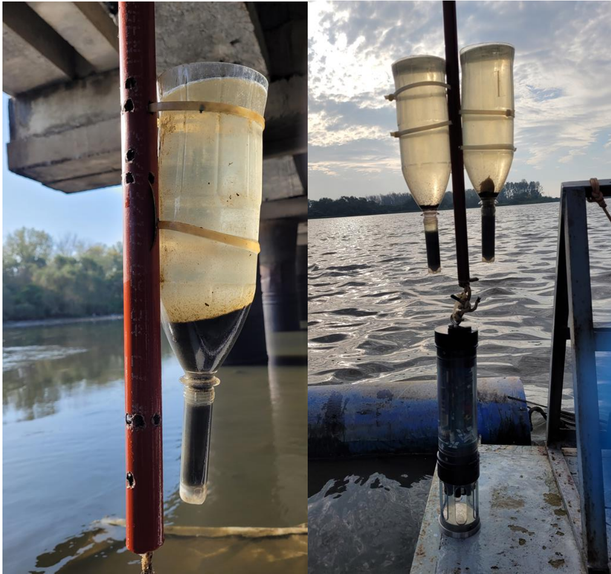
Figura 6. Trampas de sedimentos retiradas luego de 6 días de despliegue en cercanías de la desembocadura del Arroyo El Gato, muelle puerto Ing. Rocca, (izquierda; notar material oscuro desbordado del tubo Falcon inferior) y en estación fija, marina 9 del Club de Regatas La Plata (derecha, notar sonda multi-paramétrica bajo las trampas instalada para registro horario de la calidad del agua).
